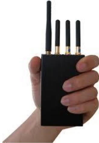
Jammer, per impedire ai telefoni cellulari di ricevere o trasmettere.
