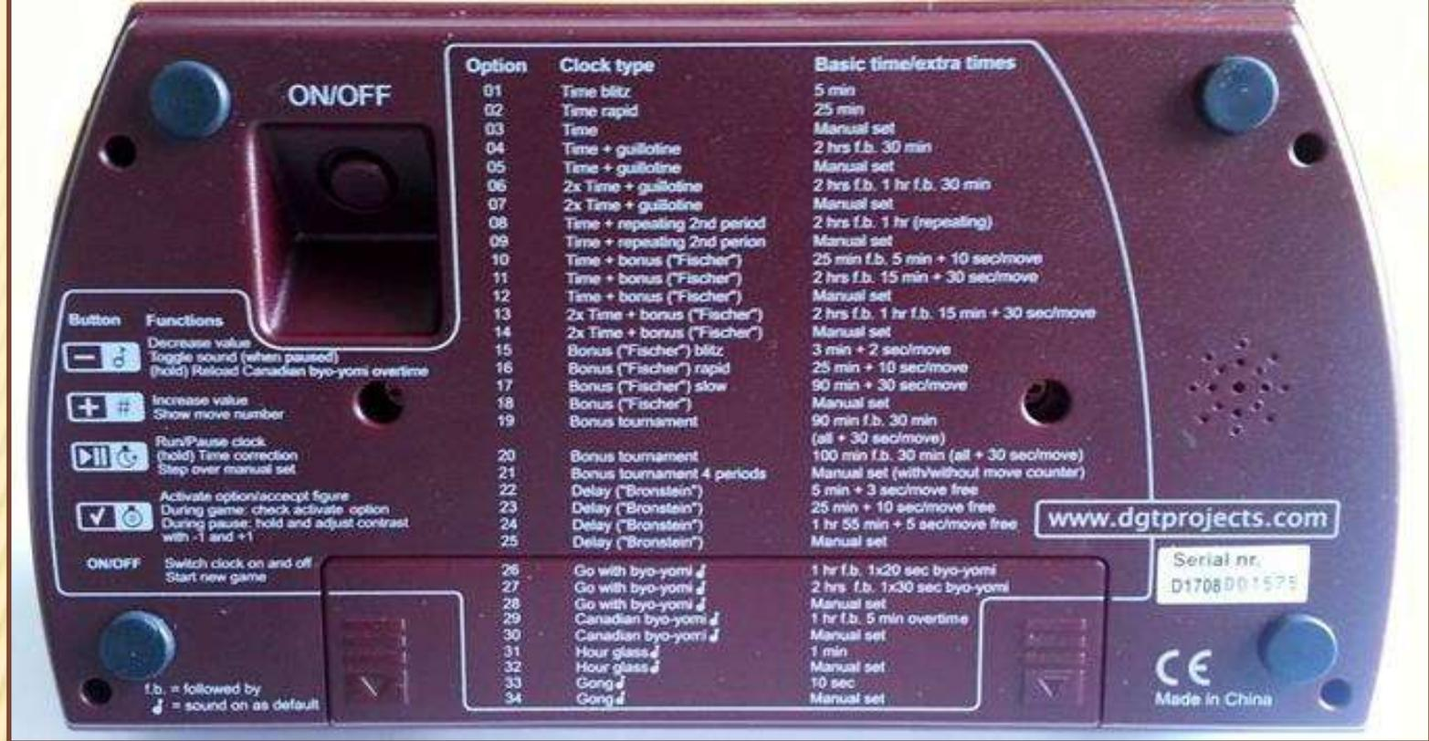
Alla base dell'orologio sono riportate tutti i programmi di settaggio, il tasto di accensione e spegnimento e l'alloggio per le batterie (2 batterie AA). Ci soffermeremo sui programmi maggiormente utilizzati per cercare di comprendere al meglio l'utilizzo dell'orologio:
