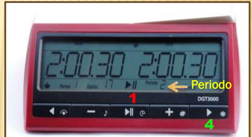
Selezioniamo con i tasti **2** e **3** il programma di settaggio **17** con due tempi predeterminati: 2h + 15m + 30 sec./move free ( Brostein ). Scelto il programma selezioniamolo con il tasto **4** poi con il tasto **1** mettiamo in moto l'orologio.
