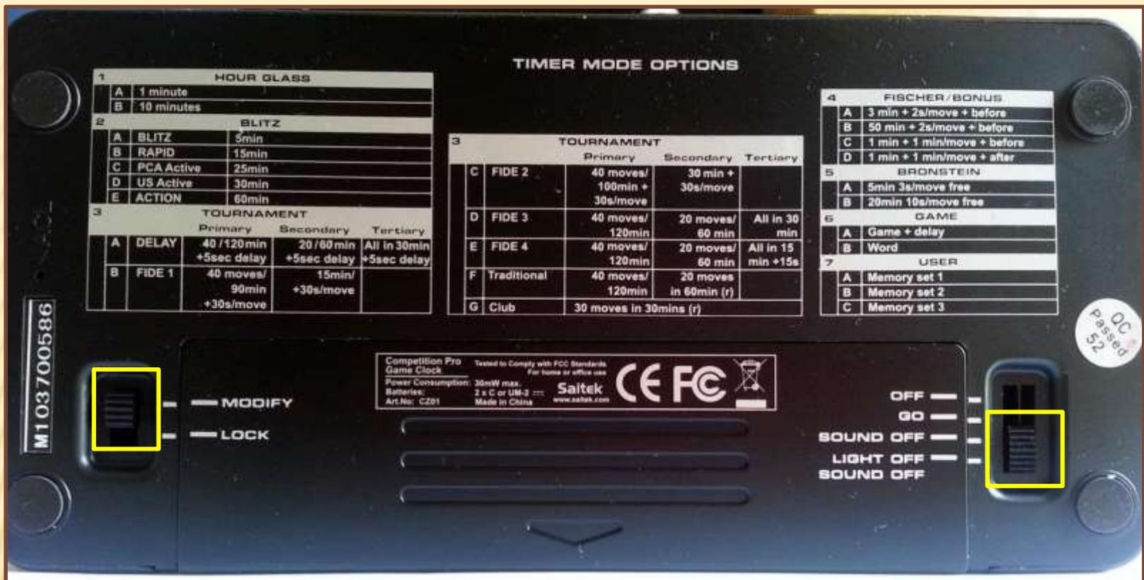
In questa immagine invece, l'orologio risulta acceso e sbloccato. E' importante ricordare che per accendere l'orologio bisogna abbassare l'interruttore di destra fino in fondo (**LIGHT OFF - SOUND OFF**), in modo da disattivare sia il suono che la luce, per non arrecare disturbo ai giocatori.
