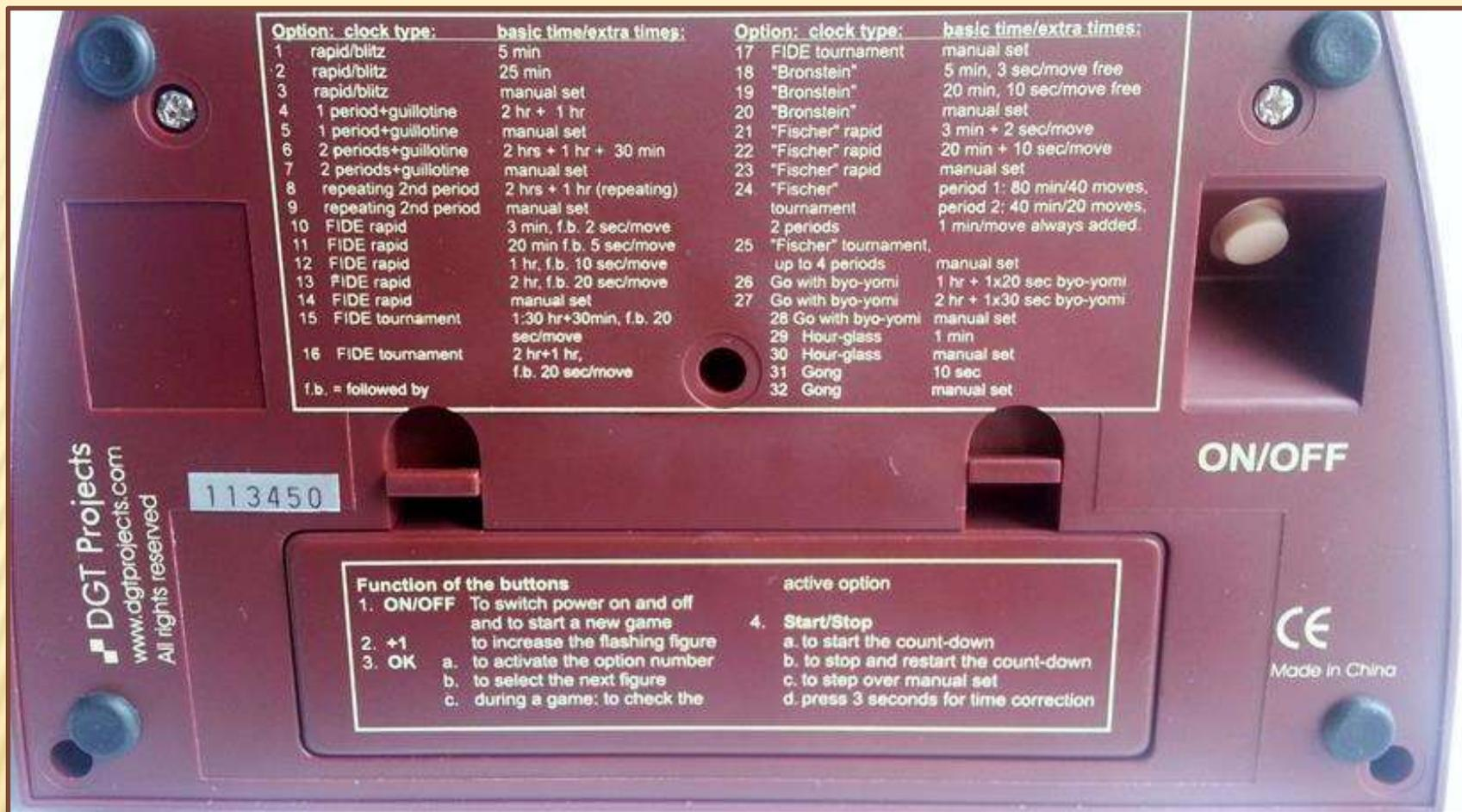
Sul fondo dell'orologio a destra troviamo il tasto dell'accensione e dello spegnimento mentre al centro in alto è presente una tabella riepilogativa di tutti i programmi del settaggio dell'orologio, nella parte inferiore è situato l'alloggio delle batterie (4 batterie AA).
