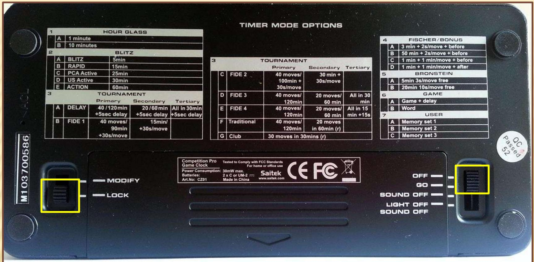
Alla base dell'orologio sono riportate tutti i programmi di settaggio; l'interruttore di accensione e spegnimento; l'interruttore che blocca/sblocca l'orologio. E' inoltre presente il vano porta batterie (l'orologio richiede 2 batterie C).
