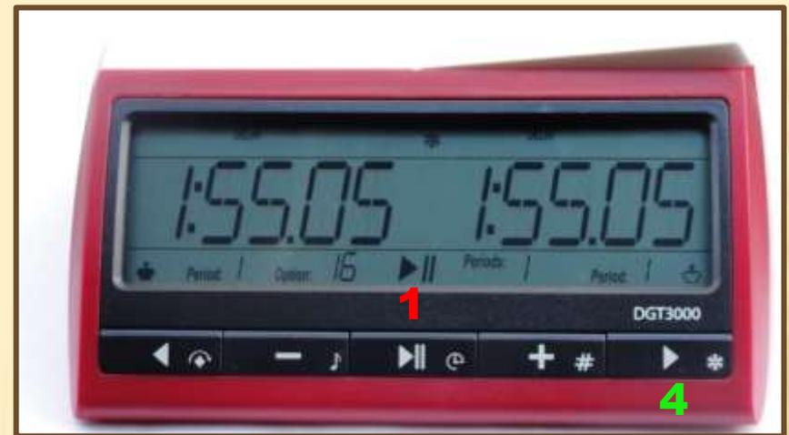
Con i tasti **2** e **3**, scegliamo il programma di settaggio **16** con il tempo predeterminato di 1h 55m + 5 sec./move free ( Bronstein ). Scelto il programma selezioniamolo con il tasto **4** poi con il tasto **1** mettiamo in moto l'orologio.
