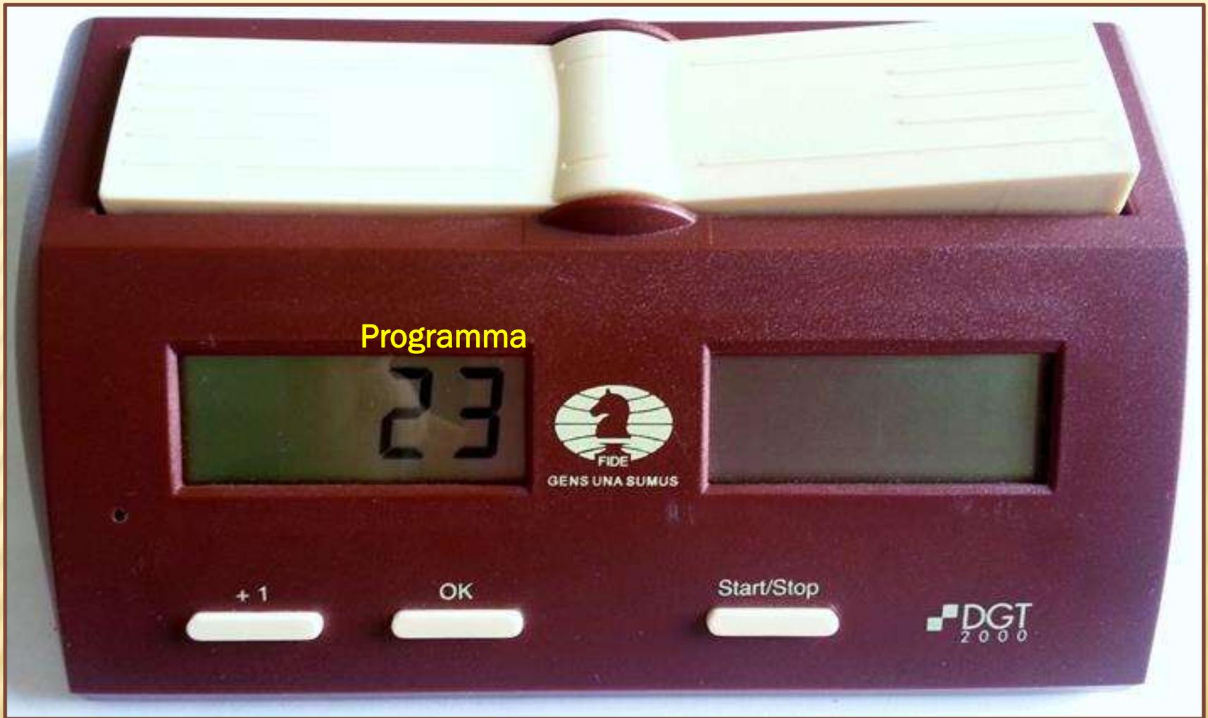
Con il programma **23** possiamo settare un unico periodo di gioco con l'incremento. Quindi una volta acceso l'orologio con il tasto **+1** selezioniamo il programma **23** e digitiamo il tasto **OK**.
