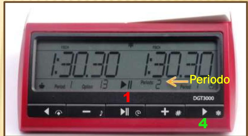
Ora con i tasti **2** e **3**, scegliamo il programma di settaggio **13** con due periodi predeterminati: 1h 30m + 30m + 30 sec/move bonus. Una volta scelto selezioniamolo con il tasto **4** poi con il tasto **1** mettiamo in moto l'orologio.
