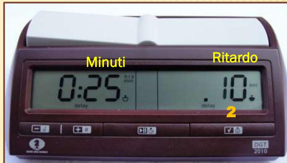
Continuando a premere il tasto **2** passiamo al controllo del contamosse, proseguiamo finché non apparirà il tempo predeterminato. Finito il controllo con il tasto **1** avviamo il tempo.
