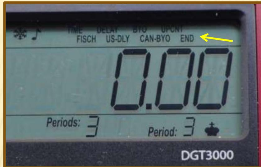
Terminato il settaggio del tempo desiderato, selezionare la funzione **END** . Ciò permette di saltare il settaggio dei periodi successivi (fino a 5 periodi) e passare direttamente alle funzioni “Freeze” e “Sound” .
