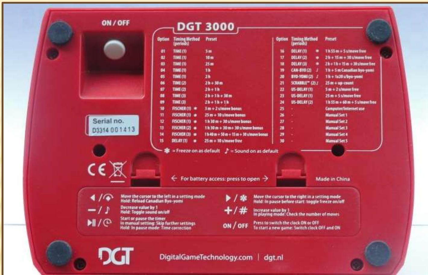
Sulla base dell'orologio sono riportati tutti i programmi di settaggio; il tasto di accensione e spegnimento. E' inoltre presente l'alloggio per le batterie (l'orologio richiede 2 batterie AA).
